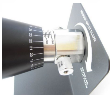
低流量アウトレットポート/固定抵抗カートリッジハウジング
